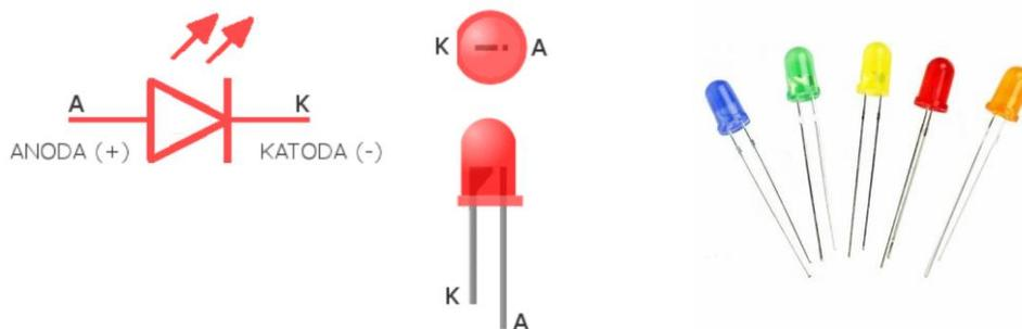
Zavisno od materijala od kojeg su izrađene i talasne dužine, diode emitiraju različitu svjetlost. LE diode prema boji priključujemo na predviđeni napon. Svaka dioda ima svoj tzv. napon praga koji mora biti osiguran kako bi dioda ispravno radila.
