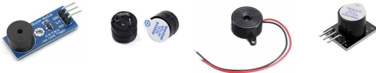
Aktivni imaju ugrađen oscillator koji generiše konstantnu frekvenciju te se aktiviraju postavljanjem stanja HIGH na pinove, dok pasivni nemaju ugrađen osciloskop i kontrolišu se dovođenjem izmjeničnog signala na pinove. Razlikuju se po tome što pasivni imaju oznaku HX na kućištu, dok aktivni nemaju.
