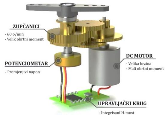
Postoje četiri glavne komponente unutar hobby servo motora: DC motor, zupčanici, potenciometar i upravljački krug.
