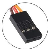
Servo motor SG 90 ima tri izvoda: napajanje, uzemljenje i upravljački signal.
