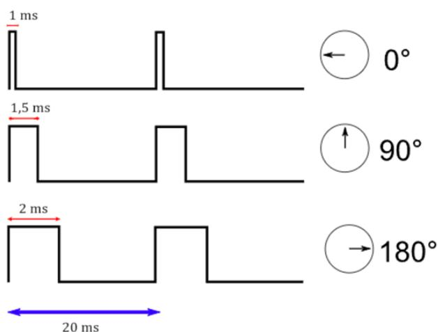
Ovim se aktuatorom može upravljati pomoću signala moduliranog širinom pulsa (PWM) od 50 Hz, koji proizvodi impuls svakih 20 milisekundi. Položaj aktuatora može se podešiti promjenom trajanja impulsa između 1 ms i 2ms i obično se mogu rotirati od 0° do 180° (imaju fizičko ograničenje kretanja). Položaj servo uređaja može se kontrolisati samo PWM signalom.
